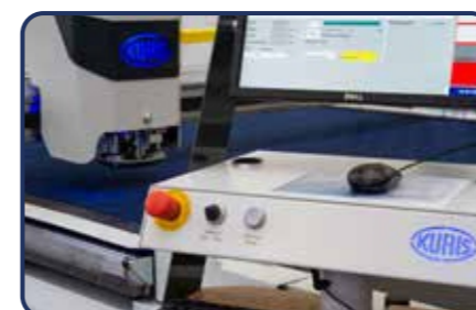
Cabeçote de corte com luz indicativa de operação LED
